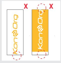
Das im Datenblatt angegebene Druckmaß umfasst die sichtbaren und nicht sichtbaren Bereiche des Grafikträgers. Bitte legen Sie die Druckdatei immer auf das Druckmaß unter Berücksichtigung des Sichtmaßes an. Hintergrundgrafiken und -bilder/-texturen sollten über das gesamte Druckmaß angelegt, wichtige grafische Elemente, die beschnittlos sichtbar sein sollen, müssen innerhalb des Sichtmaßes platziert werden.
